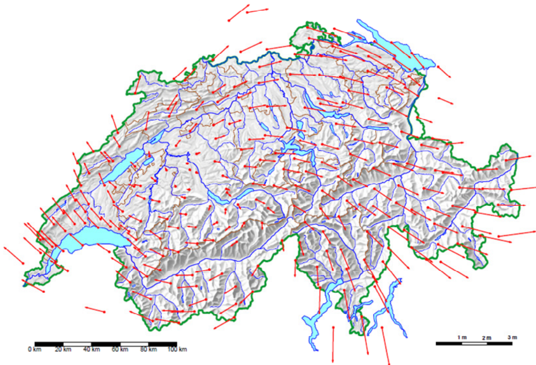
Abb.: Verschiebungsvektoren vom alten Bezugsrahmen LV03 zum neuen Bezugsrahmen LV95 (Grafik aus Neue Koordinaten für die Schweiz, Bundesamt für Landestopografie, S. 11, 2006)
