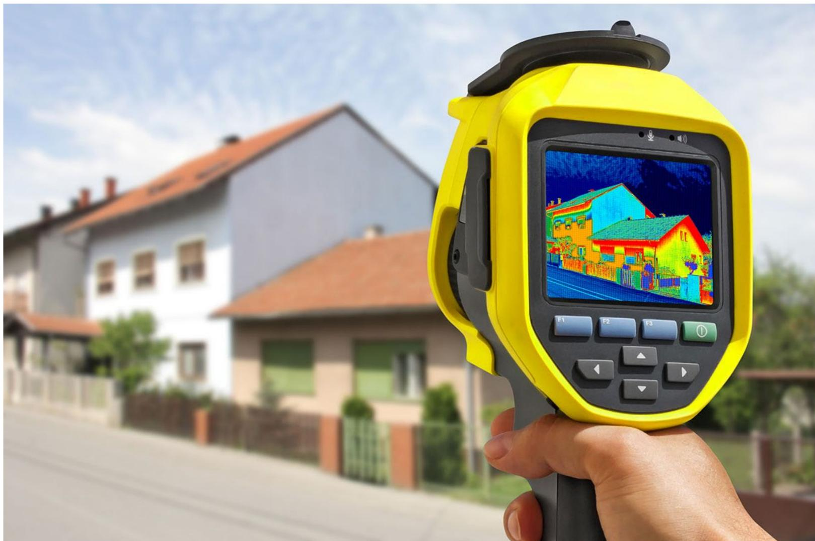
Gebäude, die schlecht gedämmt sind, haben einen hohen Energieverbrauch. Im Winter verpufft viel Heizwärme über die Schwachstellen Dach, Wände und Fenster. Über dieselben Schwachstellen überhitzen Gebäude im Sommer.
