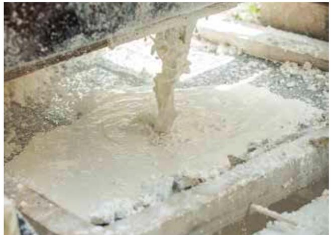
Traditionelle Herstellung von Kalk: Beschickung des Ofens mit Kalksteinen – Brand der Kalksteine bei 1000° C (vorherige Seite) – Gebrannte Kalksteine – Löschen der gebrannten Kalksteine – Sieben des gelöschten Kalks und Einfüllung in eine Grube.
