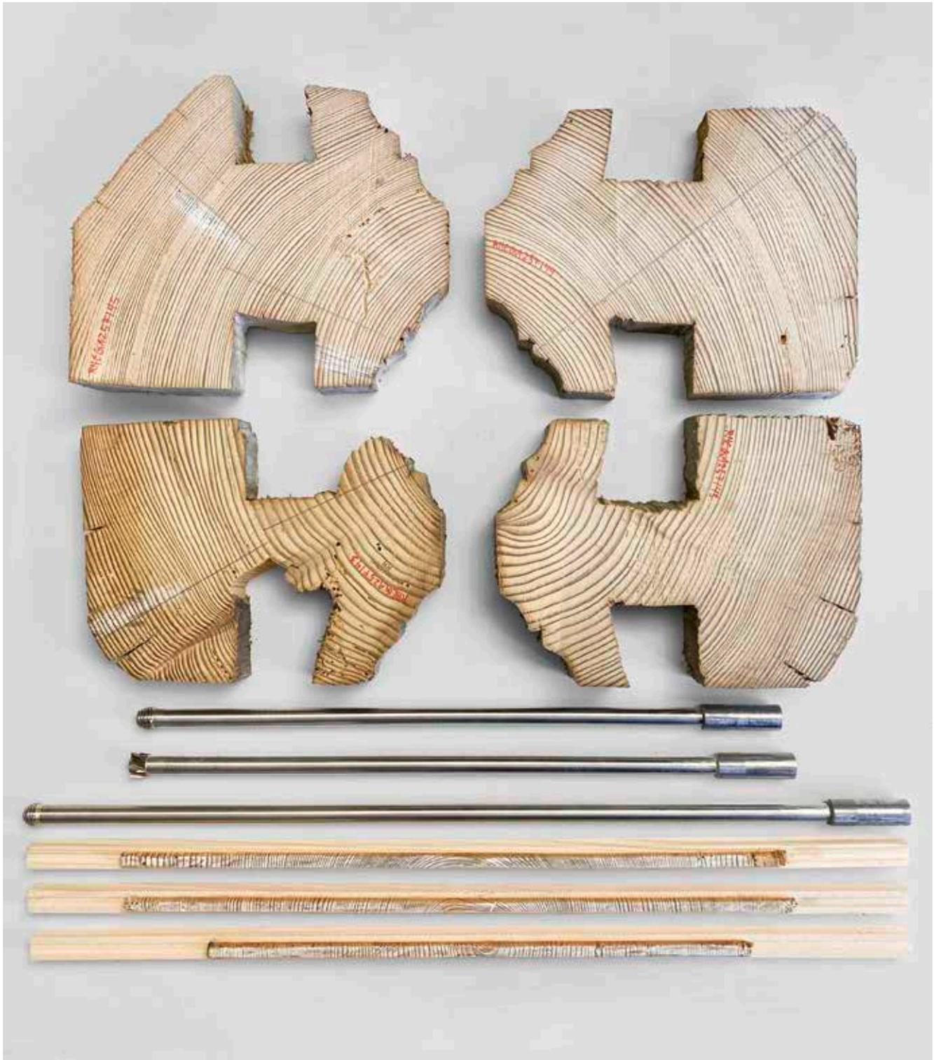
Bei den Holzscheiben im oberen Bildbereich handelt es sich um gekahlte Bälkchen einer spätmittelalterlichen Stubendecke, die aus Viertelhölzern gefertigt wurden. Sie weisen jeweils an einer Ecke eine Waldkante auf. Im unteren Bildbereich sind Hohlbohrer für die Probenentnahme und Bohrproben auf einem Trägerholz abgebildet.
