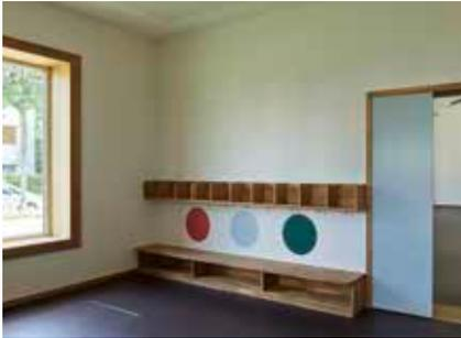
Über das neue Blumenfenster erhält die Garderobe ausreichend Tageslicht und ermöglicht Ausblicke zum Bernerring. Garderobemöbel und Fenstereinfassung sind aus robustem Eichenholz gefertigt. Die Farbkreise orientieren sich an den bestehenden Farben am Aussenbau.
