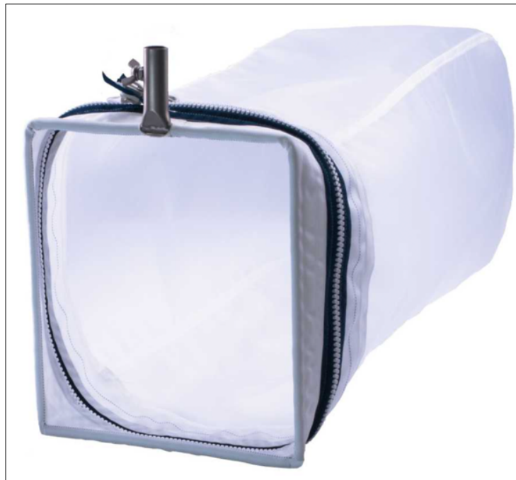
Abbildung 11: Kick-Sampling-Netz zur Entnahme flächenbezogener Kleintierproben in Fliessgewässern.
