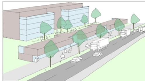
Durch eine geeignete Nutzungsanordnung kann das Lärmproblem unter Umständen deutlich reduziert werden. In der Nähe von lärmigen Anlagen (z.B. entlang von stark befahrenen Strassen oder Bahnlinien) sollten wenn immer möglich weniger lärmempfindliche Nutzungen (z.B. Gewerbe- oder Büroräume) oder lärmunempfindliche Räume angeordnet werden.
