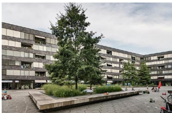
*Durch den weitgehend versiegelten Boden und die Klinkerfassaden entstehen grosse Reflexionsflächen, die für einen unangenehmen Hallraum sorgen. Alle Geräusche werden wie durch ein Megaphon verstärkt.*
