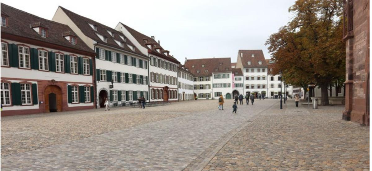
*Der Bearbeitungsgrad des Bodenmaterials erzeugt unterschiedliche Geräusche. Die von Autos in Randzeiten befahrbaren Flächen sind im Gegensatz zum Rest des Platzes abgeschliffen, was die Fahrgeräusche abdämpft.*
