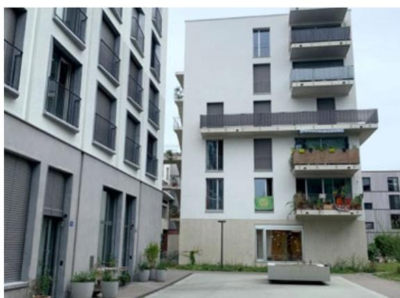
*In dieser Hofsituation mit versiegeltem Boden und einem ungünstig platzierten, kleinen Brunnen wird der Schall der Umgebungsgeräusche kaum absorbiert, sondern vielfach reflektiert und somit verstärkt.*
