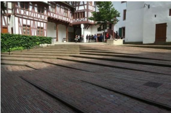
*An den Stufen und den strukturierten Oberflächen wird der Schall diffus reflektiert. Mit jeder Stufe aufwärts öffnet sich der Hörbereich.*
